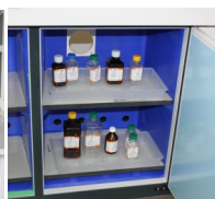
На полках полиэтиленовых тумб вытяжного шкафа
